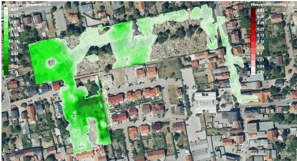
Abbildung 5: Differenzen der maximalen Wassertiefen beim 100-jährlichen Hochwasser, Plan-Zustand minus Ist-Zustand (Quelle Luftbild: s. Abbildung 3)
