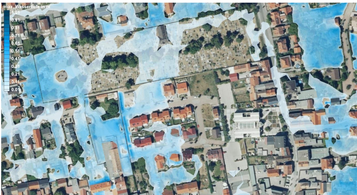
Abbildung 3: 100-jährliche Überschwemmungsflächen und Wassertiefen im Plangebiet und seinem näheren Umfeld, Ist-Zustand (Quelle Luftbild: Esri, DigitalGlobe, GeoEye, Earthstar Geographics, CNES/Airbus DS, USDA, USGS, AeroGRID, IGN, and the GIS User Community)
