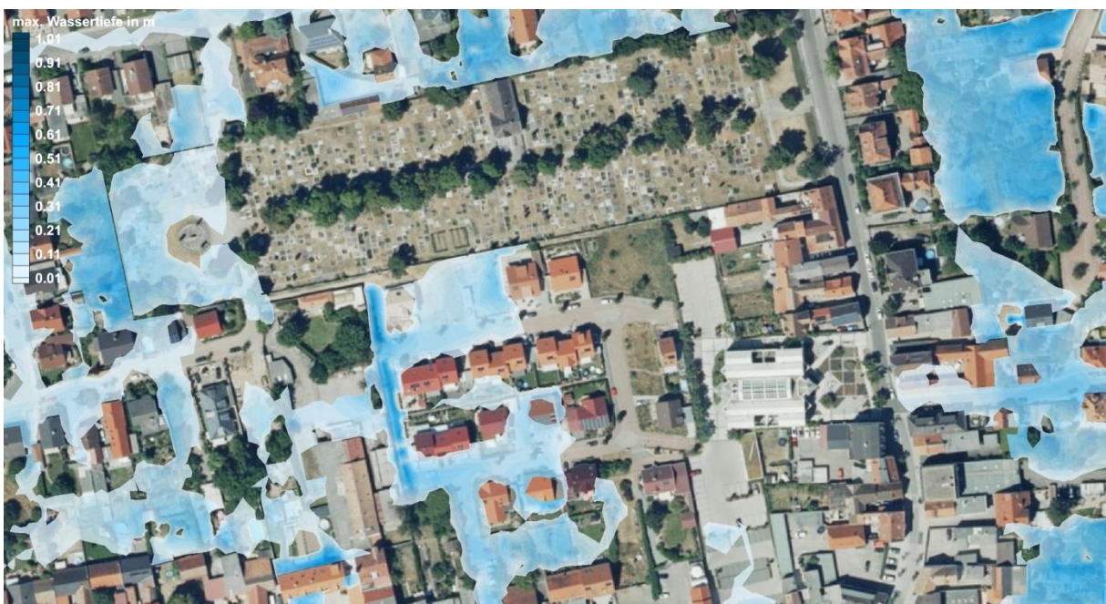
Abbildung 4: 100-jährliche Überschwemmungsflächen und Wassertiefen im Plangebiet und seinem näheren Umfeld, Plan-Zustand (Quelle Luftbild: s. Abbildung 3)
