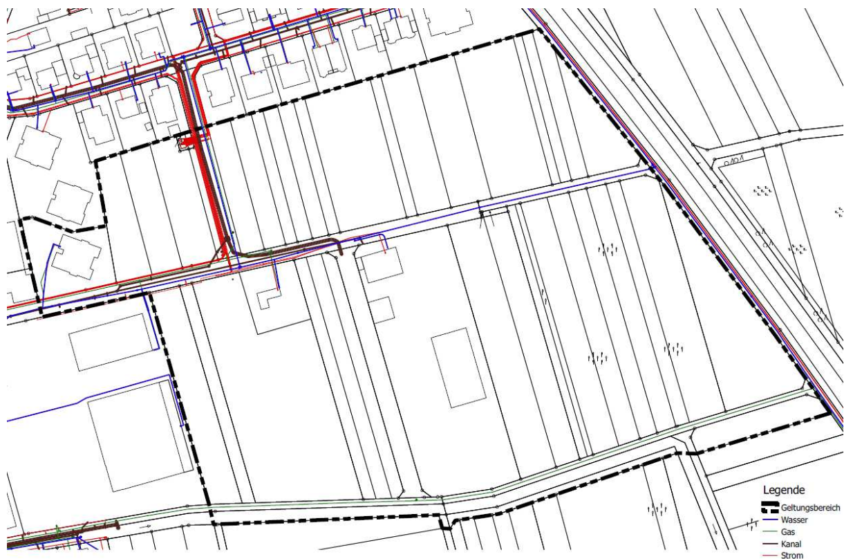
Abbildung 24: Bestand an Ver- und Entsorgungsleitungen
