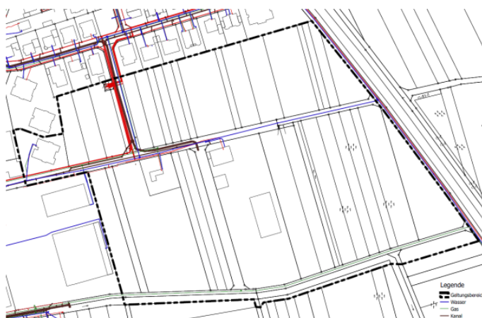
Abb. 10: Bestand an Ver- und Entsorgungsleitungen
