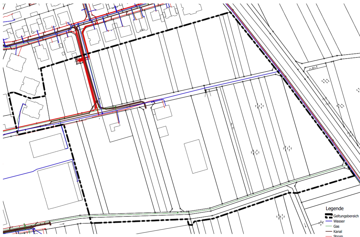
Abbildung 28: Bestand an Ver- und Entsorgungsleitungen
