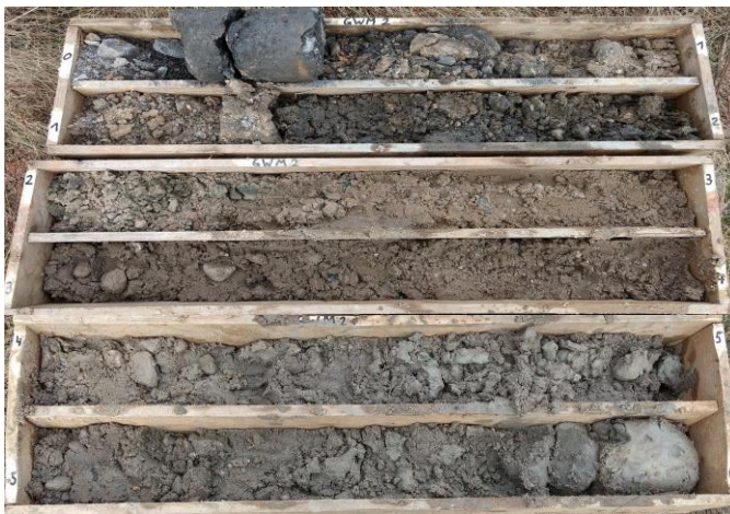
Bild 3: Exemplarische Nahaufnahme des aufgeschlossenen, in Kernkisten ausgelegten Bohrgutes von GWM 2.
