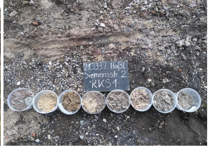
Bild 2: Blick auf das bei RKS/RP 1 aufgeschlossene und beprobte Bodenmaterial, das keine organoleptischen Auffälligkeiten zeigte.
