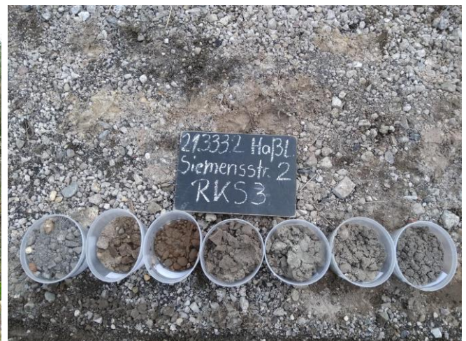
Bild 6: Mit Ausnahme der Auffüllung (1. Dose v. li.) organoleptisch unauffälliges Bodenmaterial v. RKS/RP 3
