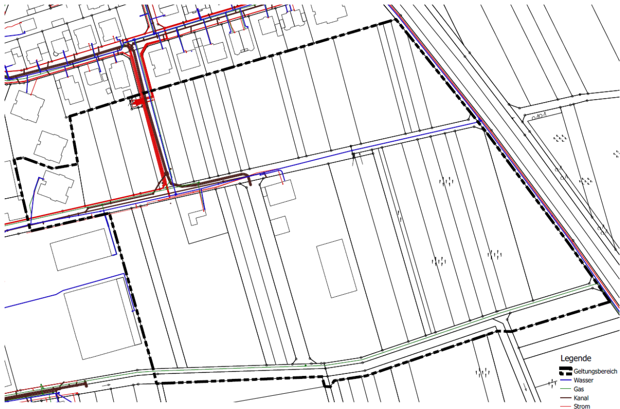
Abbildung 28: Bestand an Ver- und Entsorgungsleitungen
