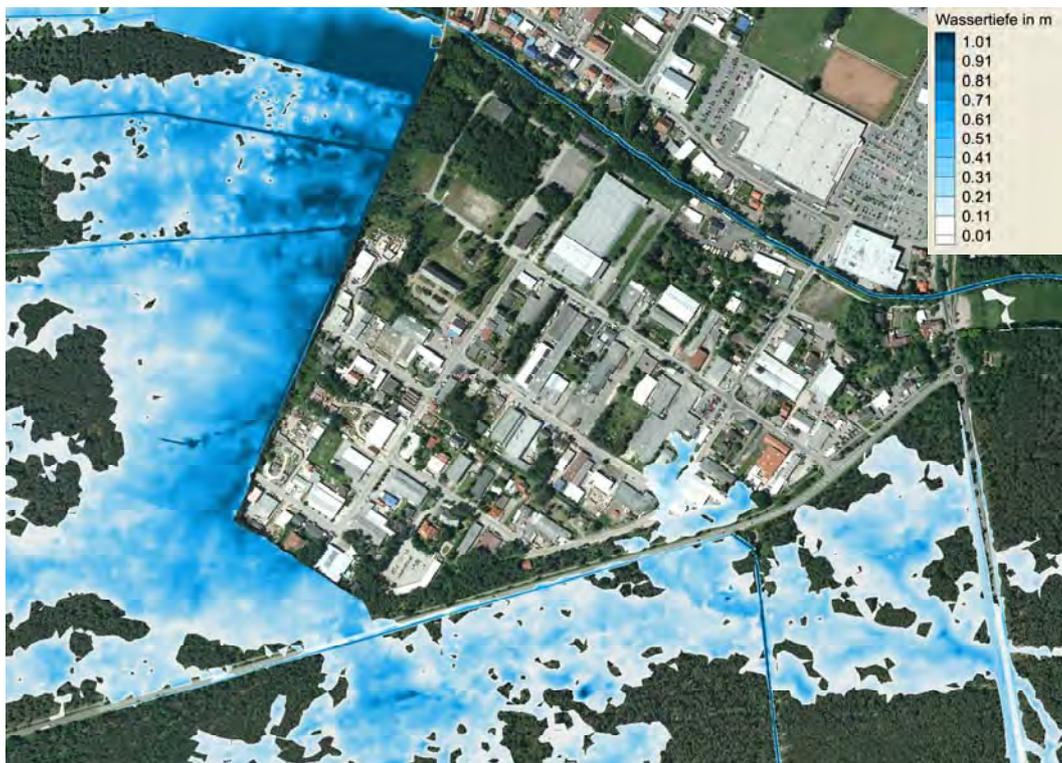
Abbildung 50: Betroffenheit im Industriegebiet Süd in der Variante K2 durch Rückströmung durch den Durchlass am Graben an der Mörderrichtstelle
