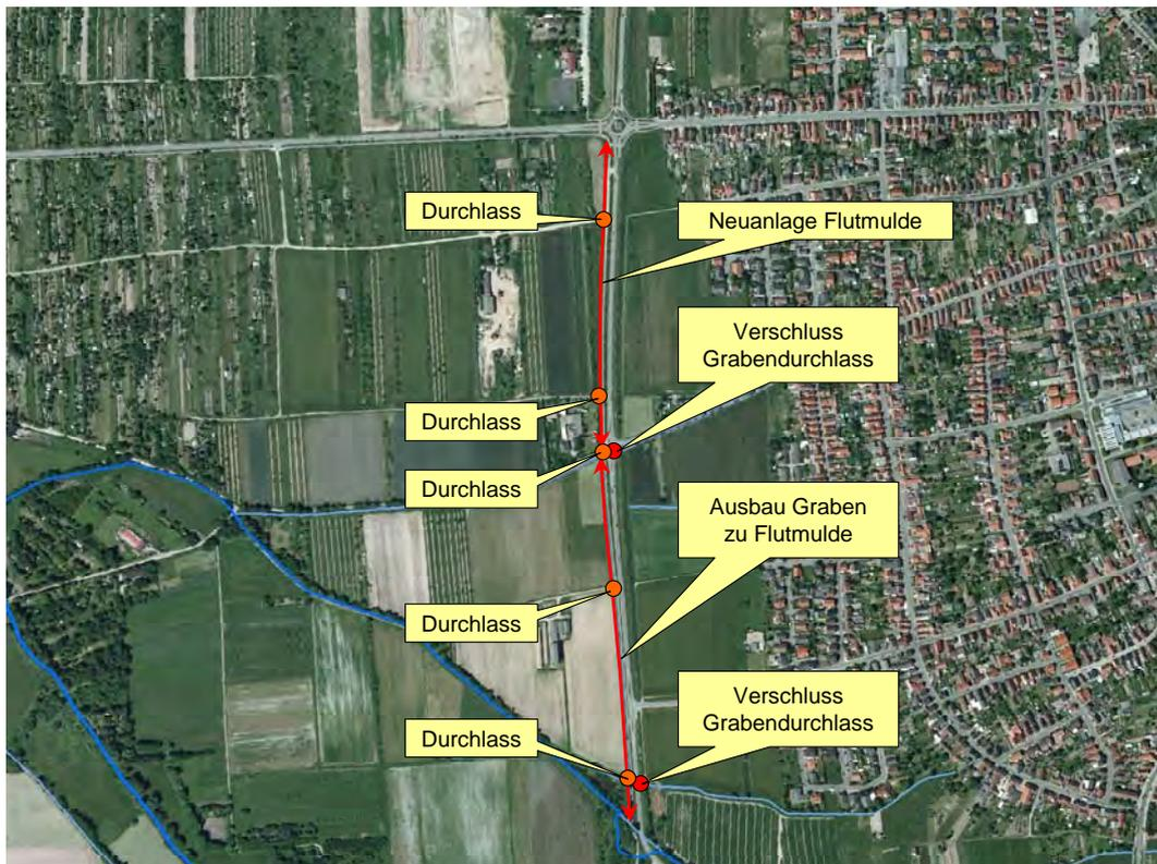
Abbildung 19: Maßnahmen der Variante H3 zum Schutz von Haßloch-West
