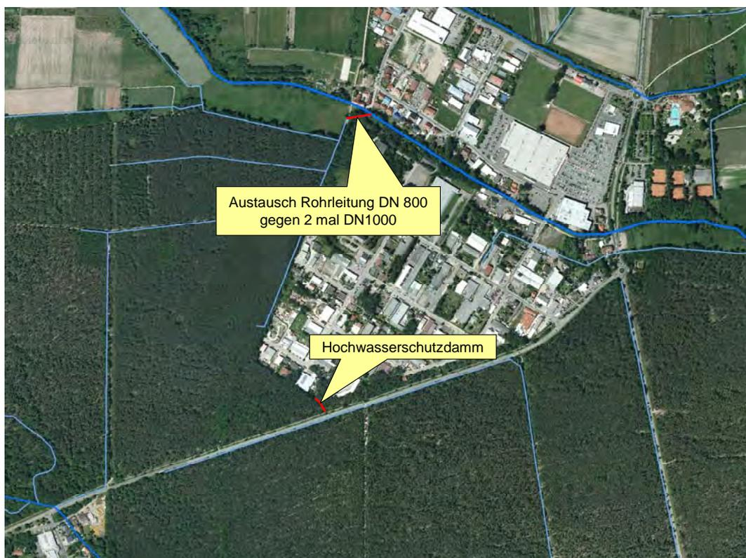
Abbildung 25: Maßnahmen der Variante I2 zum Schutz des Industriegebiets Süd
