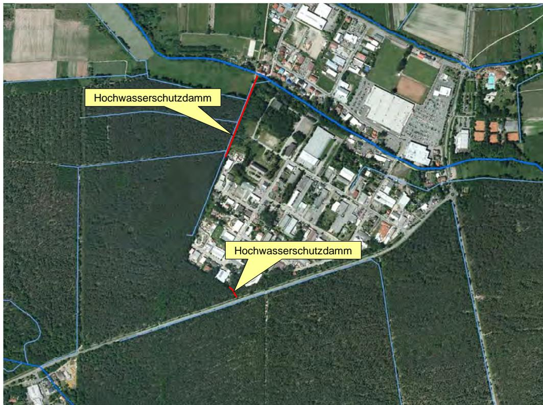
Abbildung 21: Maßnahmen der Variante I1-1 zum Schutz des Industriegebiets Süd
