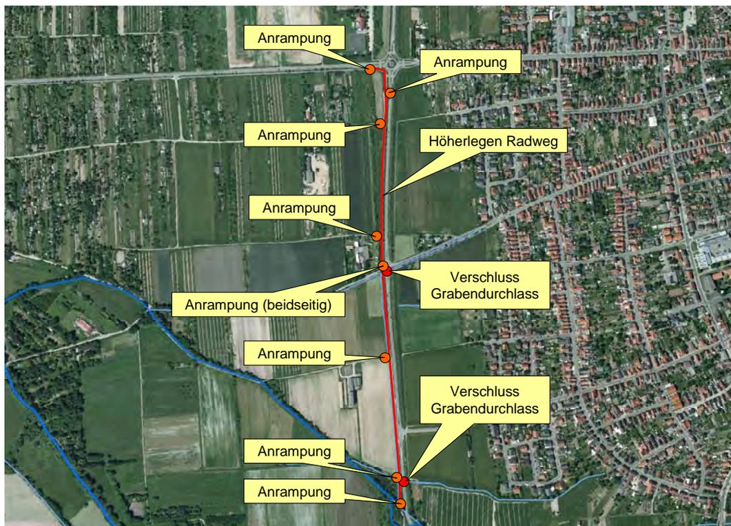
Abbildung 17: Maßnahmen der Variante H2 zum Schutz von Haßloch-West
