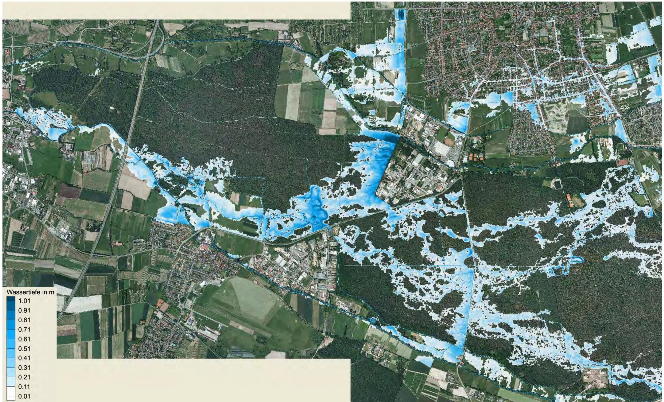
Abbildung A-2.11: 100-jährliche Überschwemmungsflächen und Wassertiefen in der Variante H5 der örtlichen Hochwasserschutzmaßnahmen für Haßloch
