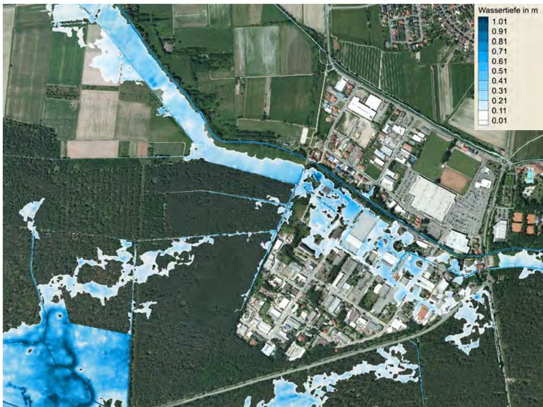
Abbildung 46: Betroffenheit im Industriegebiet Süd bei Kombination der Varianten H1 und R4-3 und Vergrößerung der Rohrleitung DN 800 an der Obermühle auf zweimal DN 1000
