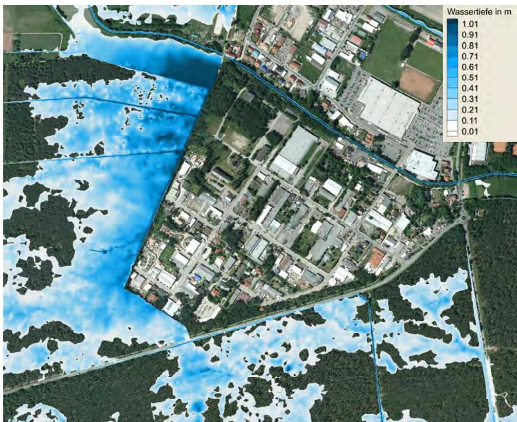
Abbildung 24: 100-jährliche Überschwemmungsflächen und Wassertiefen im Bereich des Industriegebiets Süd in der Variante I1-2
