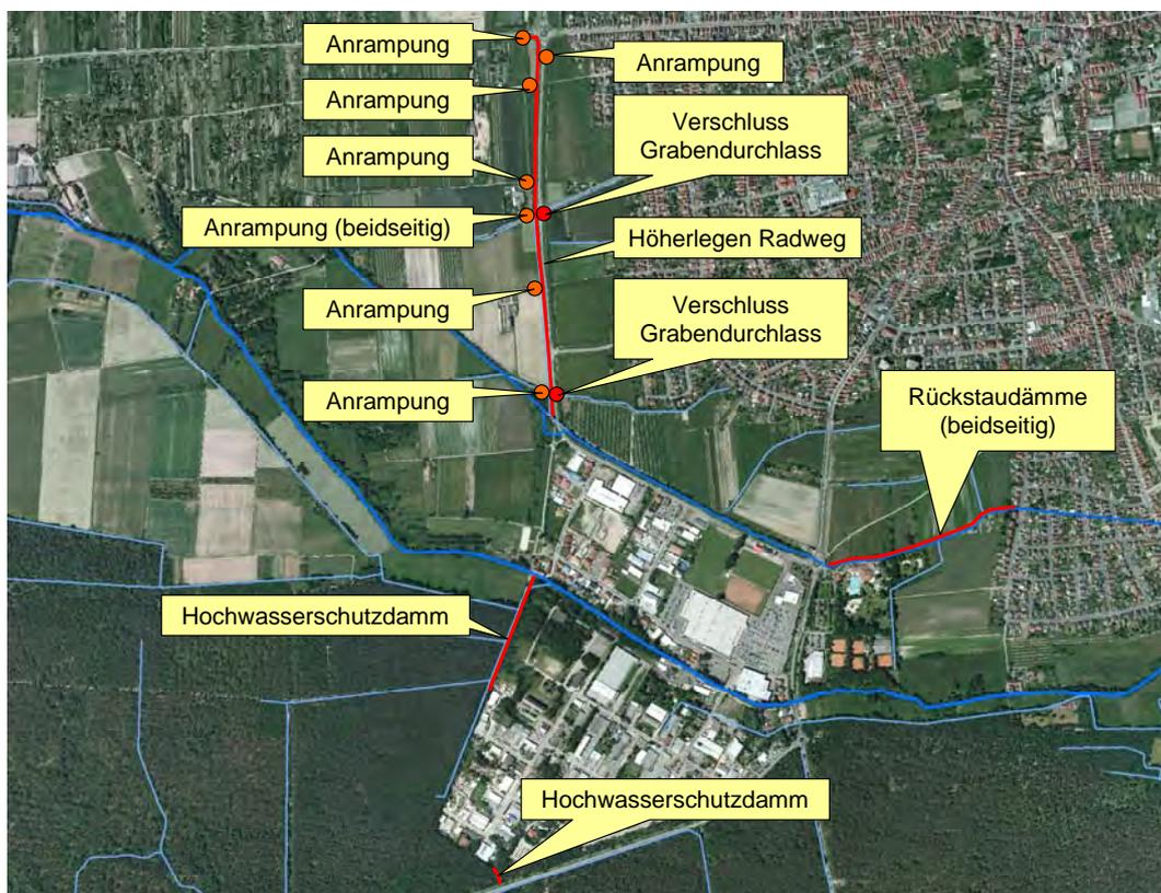
Abbildung 33: Maßnahmen der Variante H5 zum Schutz von Haßloch-West und des Industriegebiets Süd
