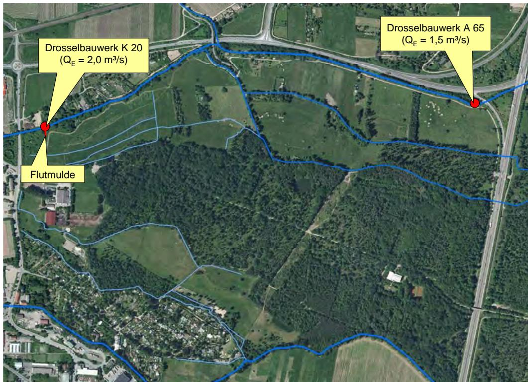
Abbildung 38: Maßnahmen der Variante R23-1 zum Schutz von Haßloch
