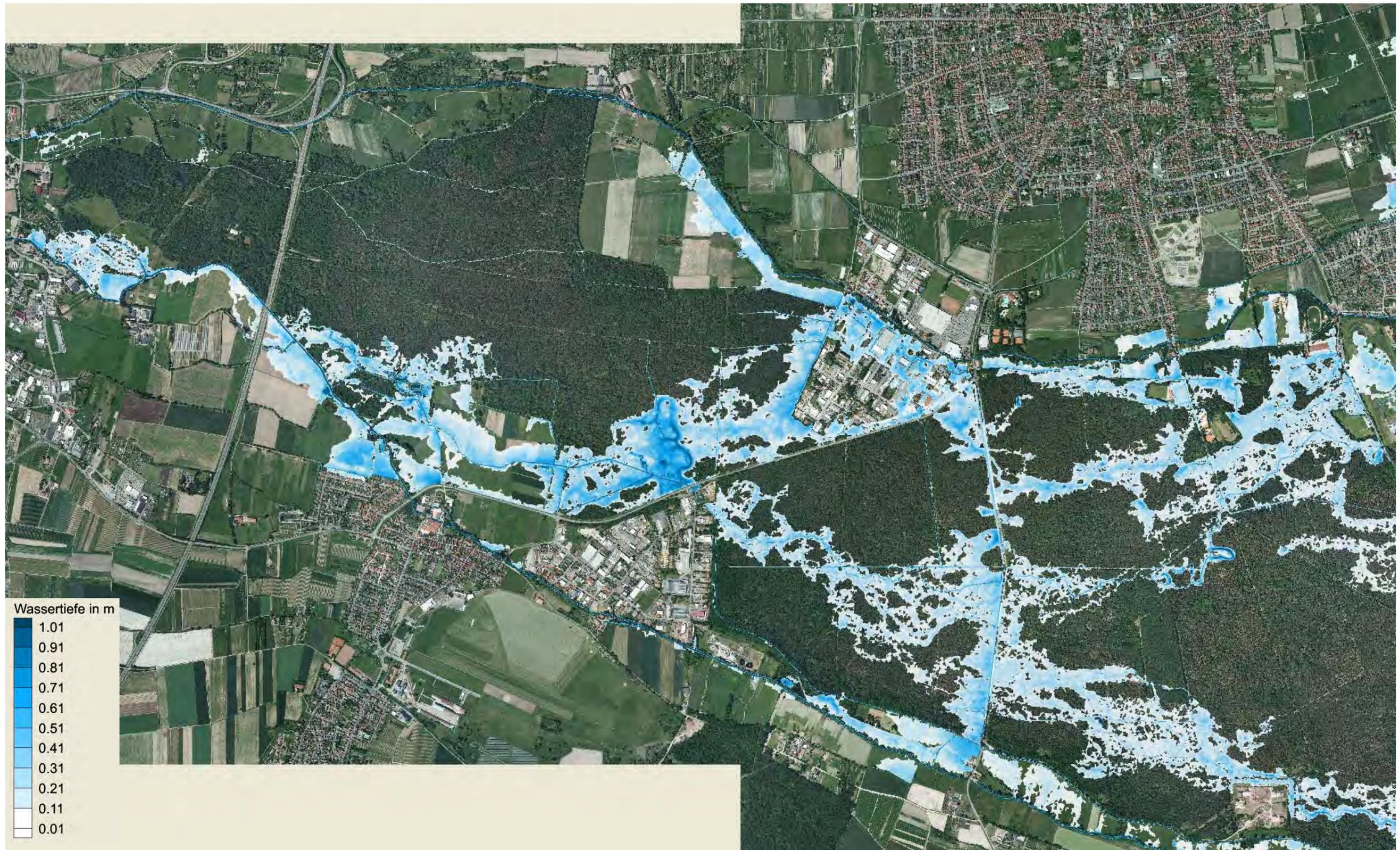
Abbildung A-2.1: 100-jährliche Überschwemmungsflächen und Wassertiefen in der Variante H1 der örtlichen Hochwasserschutzmaßnahmen für Haßloch
