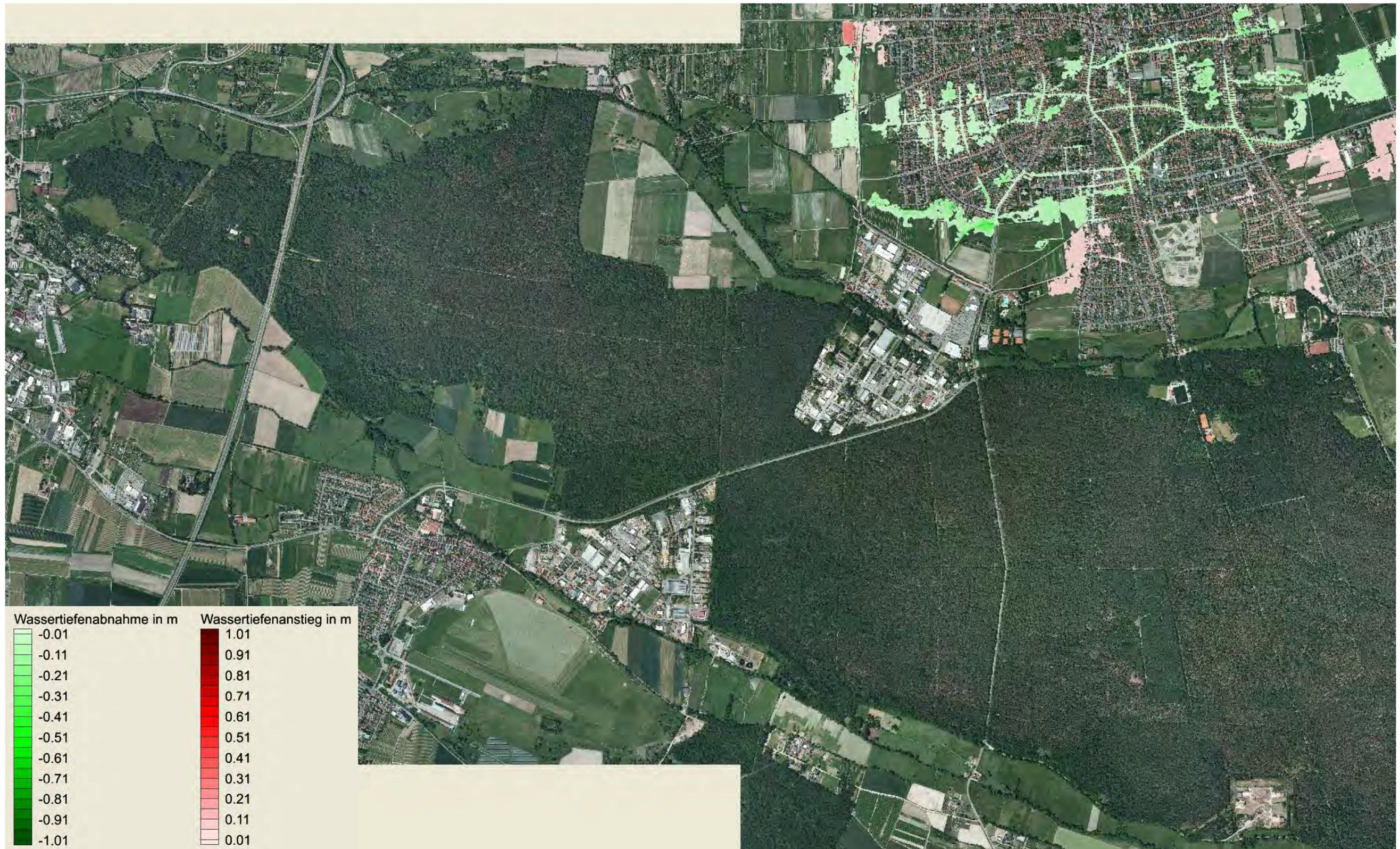
Abbildung A-2.6: Unterschiede in den 100-jährlichen Überschwemmungsflächen und Wassertiefen zwischen der Variante H3 der örtlichen Hochwasserschutzmaßnahmen für Haßloch und dem Referenz-Zustand
