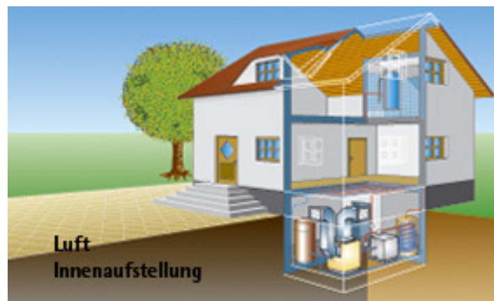
Abbildung 2-3 Wärmepumpenanlage Luft/Wasser Innenaufstellung (Quelle: Bundesverband WärmePumpe (BWP) e. V.)
