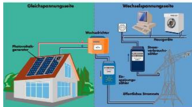
Abbildung 2-16 Schemazeichnung und netzgekoppelte Anlage (Quelle: CD Solarenergie)
